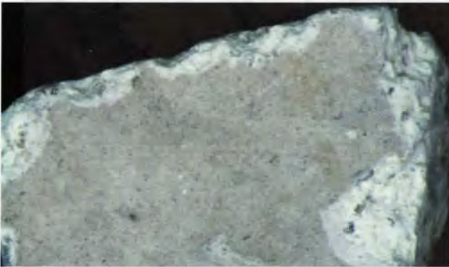
7 - CAMPIONE 5 - IMMAGINE ALLO STEREOMICROSCOPIO - FRAM- MENTO DALLA SPECCHIATURA MARMOREA DIPINTA CON STESURA PITTORICA GIALLO BRUNO CHIARA E INTONACO DI FINITURA Sample 5 - Image by stereo-microscope - Fragment of pain- ted marble surface with pale yellowish-brown colour, and plaster finish
