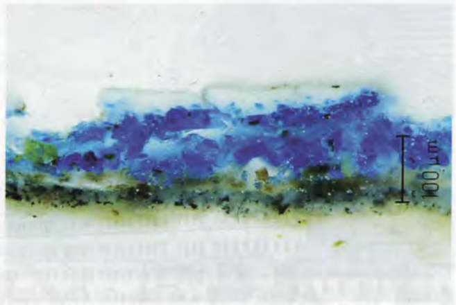
20 - CAMPIONE 9L BIS - SAN GREGORIO, COLOMBA SU AZZURRITE: 1 - STRATO GRIGIO (60 µm) 2 - STRATO DI AZZURRITE CON BIANCA (100 µm) 3 - STRATO DI BIANCA DISCONTINUO (COLOMBA) FLUORESCENTE (40 µm)
