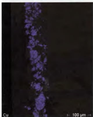
6a – STESSO CAMPIONE OSSERVATO AL SEM-EDS, 250x E MAPPE A RAGGI X PER CALCIO (CA), RAME (CU), PIOMBO(PB)
