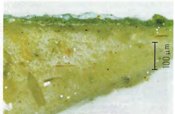
24 - CAMPIONE 26L - CONTROFACCIATA, RAGGIO DAL TRONO SULLA BANDIERA: 1 - INTONACO 2 - STRATO DI TERRA VERDE (30 µm) 3 - STRATO DI BIANCA DISCONTINUO LIEVEMENTE FLUORESCENTE (30 µm)
