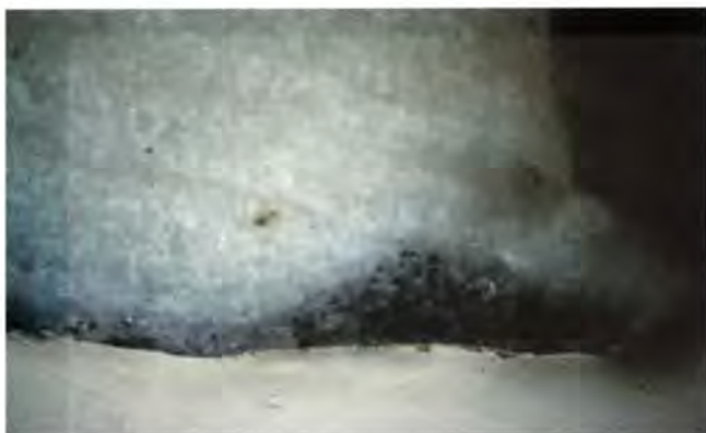
11 - CAMPIONE 4 - IMMAGINE AL MICROSCOPIO IN LUCE RIFLESSA, INGRANDIMENTO 125X - STESURA DI CALCE CARBONATATA E STRATO PIGMENTATO CON PIGMENTO NERO
