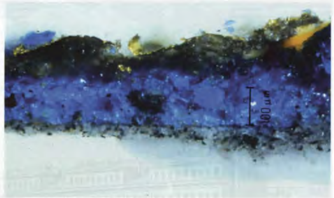
5 – CAMPIONE 22L, SEZIONE STRATIGRAFICA OSSERVATA IN LUCE RIFLESSA
