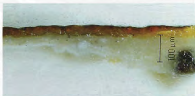
6 – CAMPIONE 19L, SEZIONE STRATIGRAFICA OSSERVATA IN LUCE RIFLESSA
