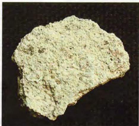
3 – PARTICOLARE DI UN FRAMMENTO DI INTONACO ORIGINALE NEL QUALE È VISIBILE LA GRANULOMETRIA DELLA SABBIA DI IMPASTO CHE CONFERISCE ALLA MALTA UN TONO CALDO, GIALLO-ROSATO
